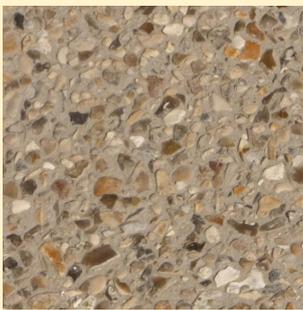
*Béton désactivé : sol en béton avec cailloux apparent, qui s'apparente à du gravier, pouvant être teinté. Rugueux et irrégulier, il interdit toute utilisation par les rollers, skateboards, et la circulation des trottinettes.*
